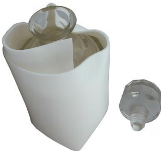
Mynd 52: Punnur pólýetýlensvampur: Volara® (einnig kallaður Alveolit®).
