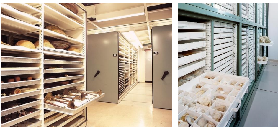
Mynd 26: Með því að nota skúffur er auðveldara að sjá alla gripi í einu. Mynd 27: Í þessu dæmi er minni þörf á pökkun vegna þess að gripirnir eru í lokuðum renniskápum sem verja þá fyrir ryki.
