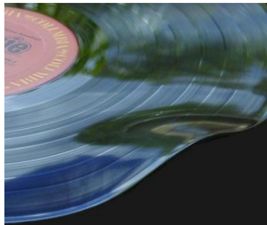
Mynd 4: Skemmd nítatrakvikmyndafilma. Mynd 5: Skemmd vínýlhjúmplata.
