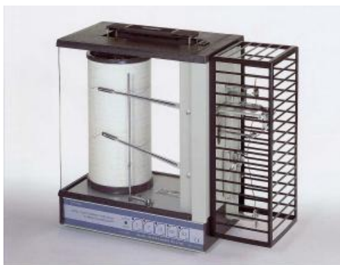
Mynd 8: Síritamælar með pappírsstrimli eru að detta út en mælar með tölvu- eða nettengingu hafa komið í staðinn. Mynd 9: Datalogger getur mælt í tvö ár samfelld. Auðvelt er að geyma gögn í slíku tæki og senda á milli tækja.
