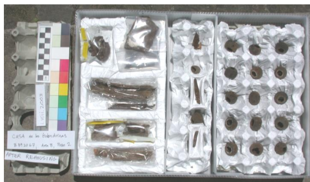
Mynd 45: Dæmi um frágang. Bakki úr pólýkarbónati. Í bakkann er notaður eggjabakki sem er fódraður með Tyvek®.
